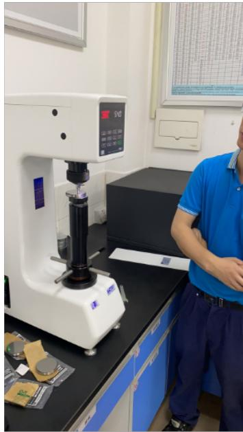
洛氏硬度计使用了三种压头、六种试验力，根据金属材料、硬度范围和大小，共可选择15个尺，非常柔软、结实，几乎可以测试所有常用金属材料，适用范围非常广。洛氏硬度计普遍应用于工业生产，成为检验产品质量、确定合理加工工艺的主要手段。洛氏硬度计可以测试各种黑色和有色金属、火焰钢、退化钢、表面硬化钢、各种厚度板、硬质合金材料、粉末冶金材料、热喷涂涂层的硬度。用基本携带的标准硬度块定期检查洛氏硬度计精度。不允许在洛氏硬度计工作台和标准硬度块上擦干净，在硬度块工作面上试验，在支承面上试验。
